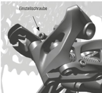
Wird die Einstellschraube (Abb. 2/73) im Uhrzeigersinn gedreht, so vergrößert sich der Abstand (Abb. 1/74) zwischen Ritzel und Leitrolle, Gegenteiliges passiert, wenn man eine Drehung gegen den Uhrzeigersinn vornimmt.
