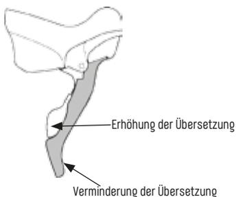
Wird dieser Hebel bis zum Anschlag nach innen geschwenkt, so schaltet das System bis zu zwei Kettenblätter auf einmal. Wird der kleinere, hinter dem Bremshebel liegende Schalthebel nach innen gedrückt, so wird eine kleinere Übersetzung eingelegt, indem die Kette von den großen auf kleine Kettenblätter springt. Mit diesem Hebel ist pro Schaltvorgang nur jeweils ein Gang zu schalten.
